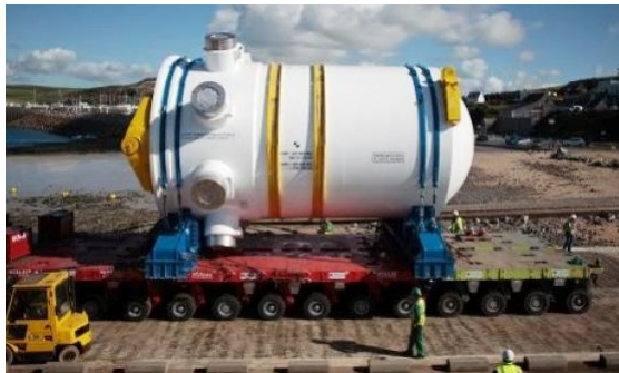
Cuve : H=13m, Ø=5.5m
