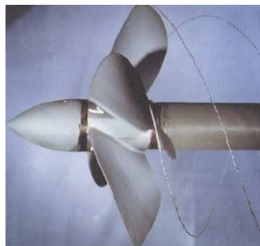
FIGURE I.4 – Cavitation par filaments sur une hélice
