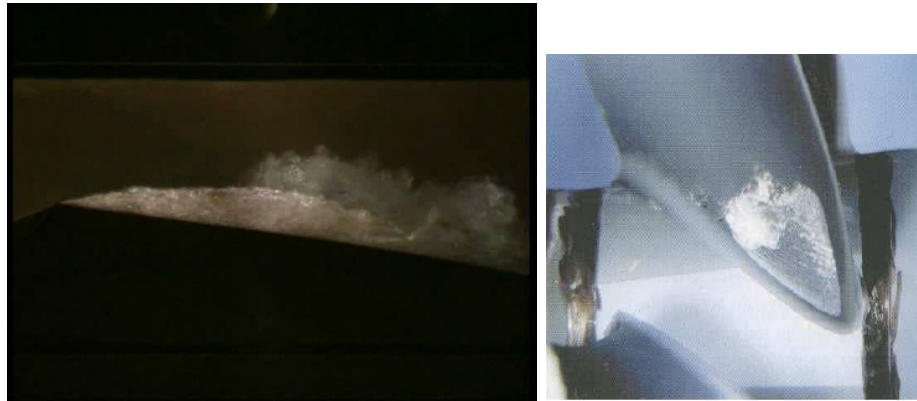
FIGURE I.3 – Cavitation par poches en Venturi (gauche) et sur hélice (droite)
